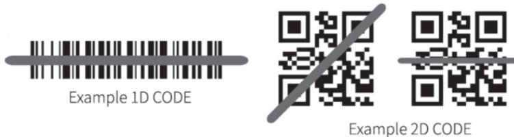
Je näher der Scanner am Barcode ist, desto kleiner wird der Strahl; weiter entfernt wird der Strahl größer. Ist der Barcode klein, sollte der Scanner nah am Barcode positioniert werden. Bei größeren Barcodes sollte der Scanner weiter entfernt platziert werden, um den Barcode korrekt zu lesen.
