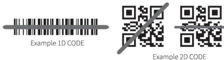
Plus le scanner est proche du code-barres, plus le faisceau devient petit; plus loin du code-barres, le faisceau devient plus grand. Si le code-barres est petit, le scanner doit être proche du code-barres. Pour les codes-barres plus grands, le scanner doit être éloigné du code-barres, facilitant ainsi la lecture correcte du code.
